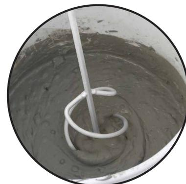
**POUR MÉLANGER JUSQU'À 5 LIVRES DE COULIS, CIMENT-COLLE ET AUTRES MATÉRIAUX DE JOINTOIEMENT**
