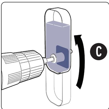
6. Insérer la mèche de perceuse dans le guide-foret. Faire pivoter le réservoir d'eau à 180° et percer le trou. **(C)**
