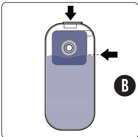
4. Ôter le capuchon sur le réservoir d'eau et remplir d'eau jusqu'au bord inférieur du guide-foret. Fixer à nouveau le capuchon fermement. **(B)**
