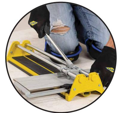
**INCLUYE UN RODEL DE CORTE DE CARBURO DE TUNGSTENO RECUBIERTO DE TITANIO DE ½ po (13 MM)**
