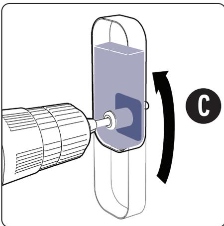
6. Inserte la broca en la guía de perforación. Gire el depósito de agua 180 grados y taladre el orificio. **(C)**
