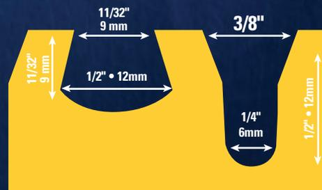
El patrón único de la alternación de las dentadas proporciona una capa de mortero más consistente y reduce los vacíos
