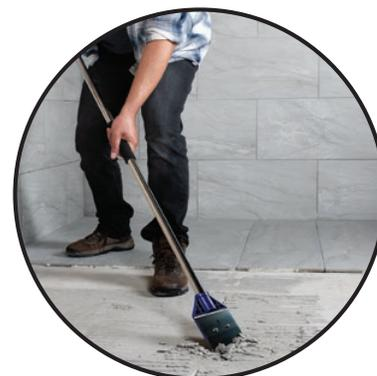
**LA CUCHILLA DE 4" (102 MM) CUBRE UNA MAYOR SUPERFICIE Y ELIMINA EFICAZMENTE LAS APLICACIONES DE PISOS ANTIGUAS.**
